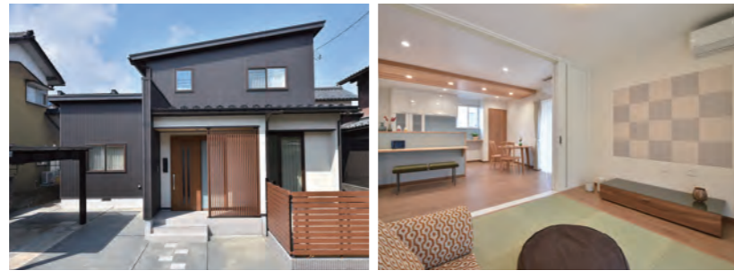
上/LDKの天井の一部にはツガを用い、空間のアクセントに。キッチン正面の造作のカウンターは、軽食をとるなど多目的に使用できる。左/メンテナンスのしやすいガルバリウムと塗り壁に、ツガを用いた玄関ポーチの天井と、道路からの目隠しも兼ねた木の格子がシックな雰囲気を醸し出す外観。右/リビングの一部に設けた量のスペースは間仕切りを開めると独立した空間となり、客間としても使用できる。
